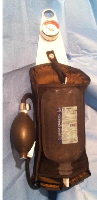
Apurador de suero o sangre de alta calidad reutilizable marca Ashcroft (U.S.A.), con manómetro graduado hasta 300 mm Hg y una malla que permite visualizar fácilmente el contenido del suero o sangre.
